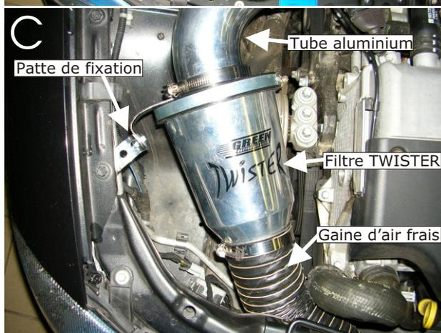
Fixer le filtre à air TWISTER à l'aide du kit de fixation fourni.(schéma B et C)
