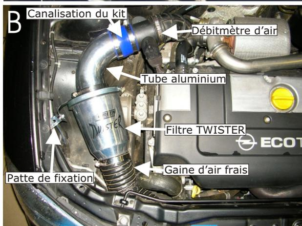
Emboîter la canalisation du kit sur le débitmètre d'air(schéma B)
