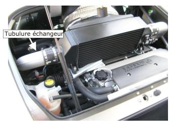
Le montage sur la LOTUS EXIGE S est identique aux deux autres modèles sauf pour le démontage de la boîte à air et l'installation du kit il faut déposer la tubulure de l'échangeur d'air voir la photo.
