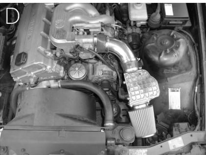
Positionner le filtre à air GREEN afin qu'il ne touche aucun organe mécanique.
