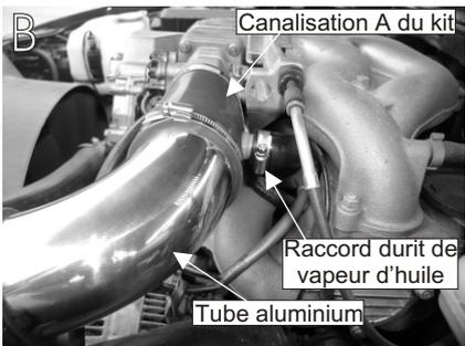
Emboîter la canalisation A du kit sur le boîtier papillon des gaz.(schéma B)
