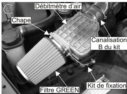
Positionner la canalisation B du kit sur le tube aluminium.(schéma C)
