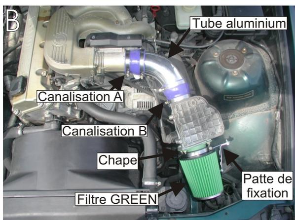
Positionner la canalisation A du kit sur le boîtier papillon des gaz.(schéma B)
