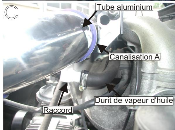
Positionner la durit de vapeur d'huile sur le raccord situé sur la canalisation A du kit.(schéma C)
