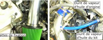
Emboîter la canalisation du kit sur le boîtier papillon des gaz.(schéma D)
