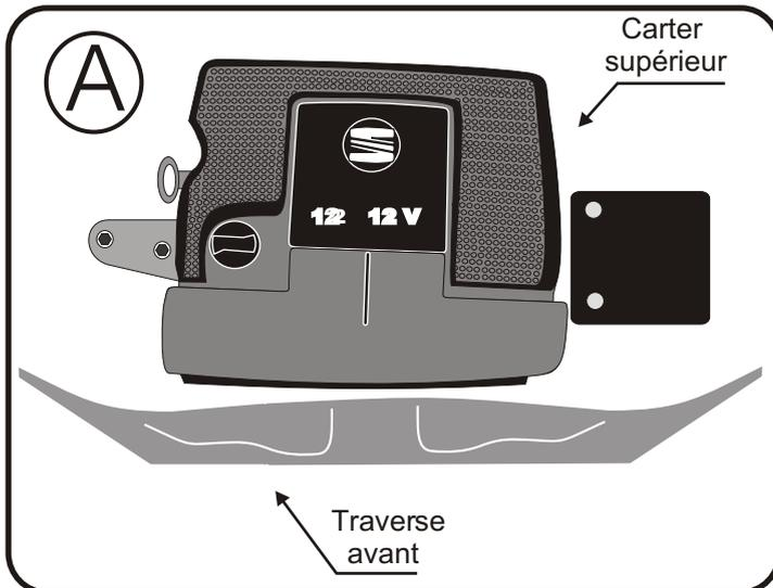
Déposer et supprimer le carter supérieur.(schéma A)
